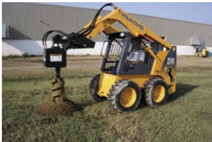
Мини погрузчик MUSTANG 2041 с гидробуром
