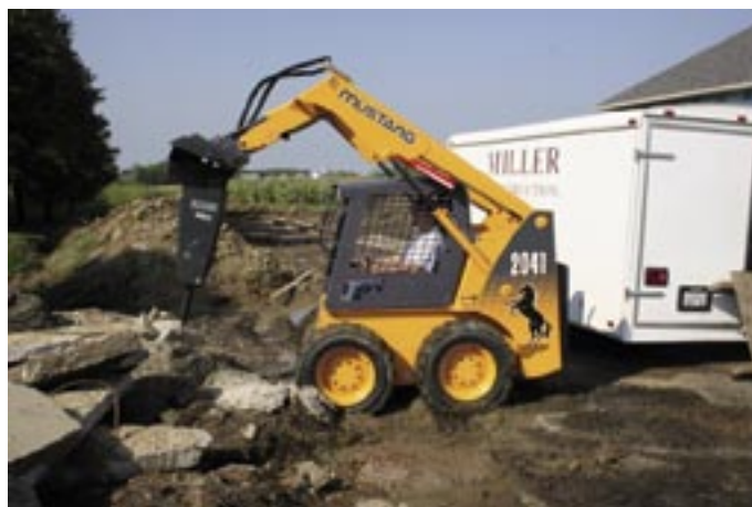
Мини погрузчик MUSTANG 2041 с гидромолотом
